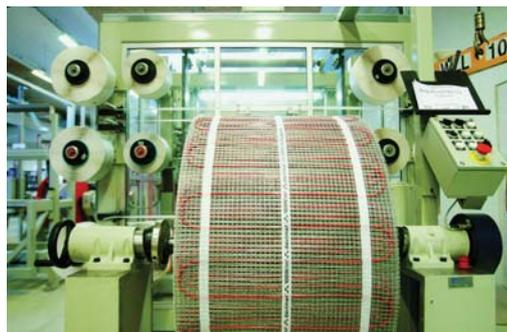
Автоматическая линия по производству нагревательных матов
