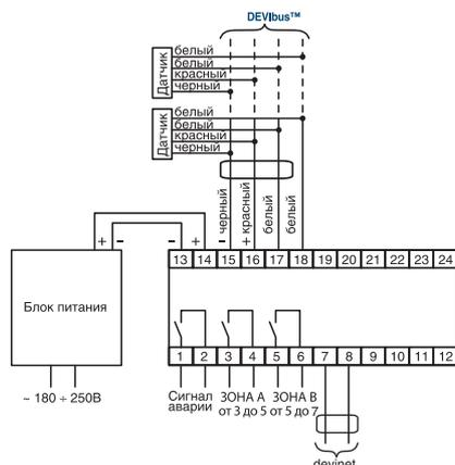
**Примечание:** При подключении трех-четырех датчиков грунта или кровли питание обеспечивается двумя блоками питания =24 В, включенными параллельно.
