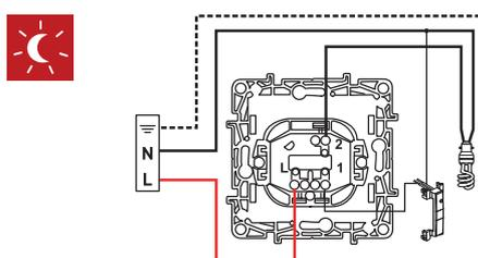
Указанный способ подключения предотвращает мерцание энергосберегающих ламп в выключенном состоянии.
