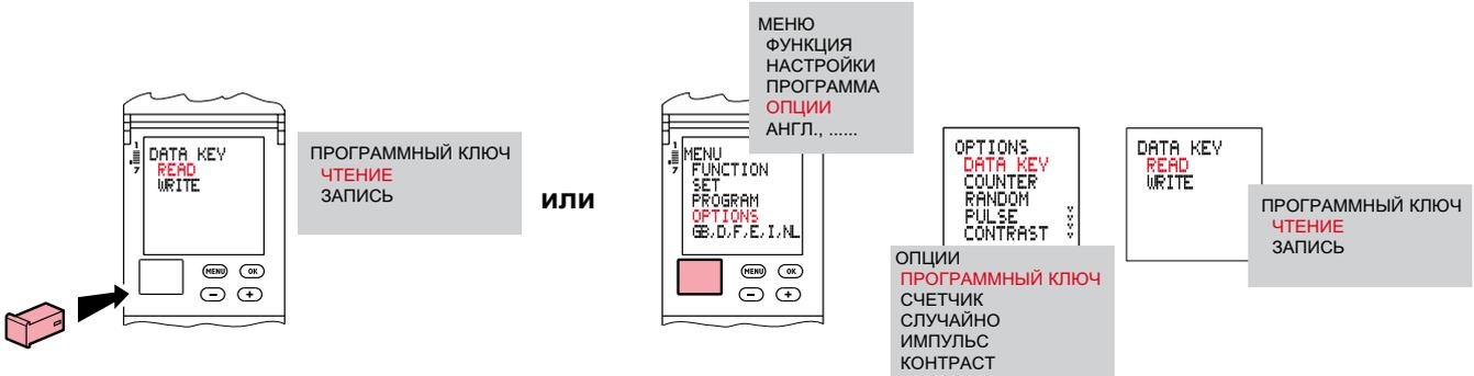
Загрузите программы из программного ключа в реле времени (операция READ KEY)
